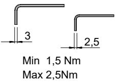
MONTAGGIO ANTA – TELAIO
